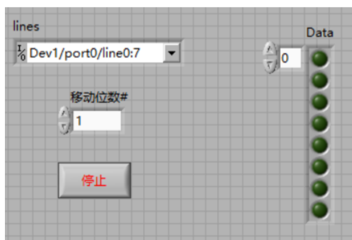
图7 实验2.1 LED灯 移位.vi 工程前面板示意图
