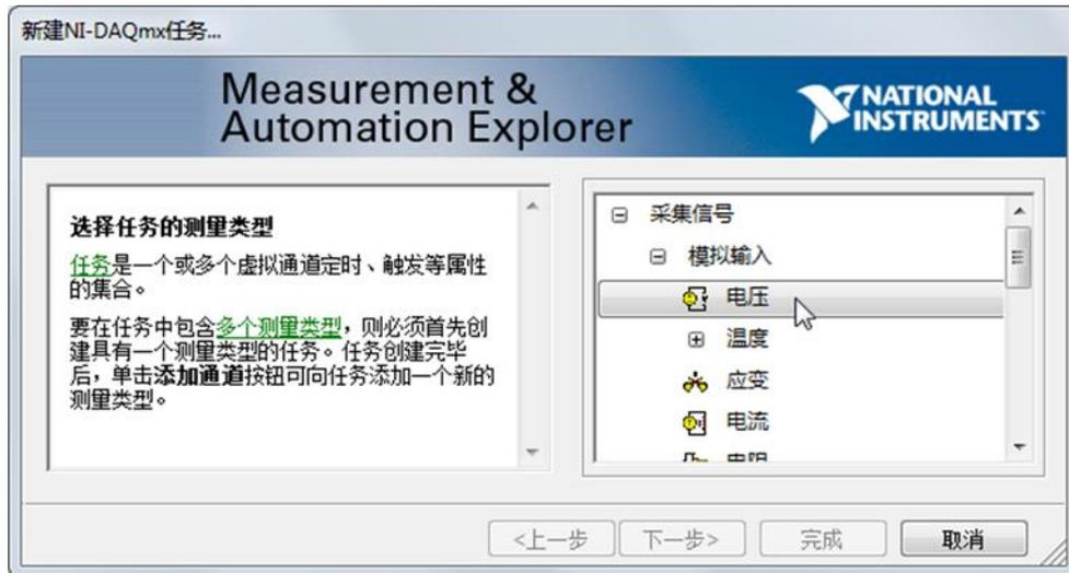
3. 因为在硬件连接上，我们是将FGEN的信号接到了ai0通道，因此在支持的物理通道中选择Dev1 (NI ELVIS II+)下面的ai0通道，如下图所示，然后点击下一步；
