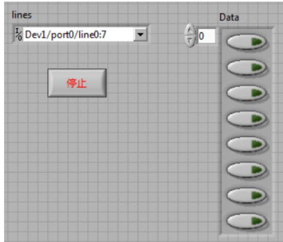
图 3-2 多路数字输出前面板示意图
